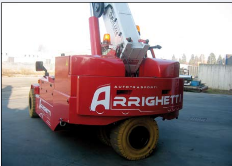
La trazione anteriore bimotores consente una sterzata anteriore "totale" della gru
