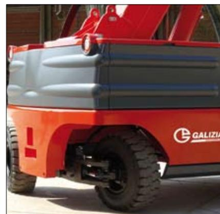
La capacità di sterzata molto stretta, con un angolo a 90° sull'asse posteriore, è assistito dalla controrotazione dei motori anteriori a corrente alternata che permettono alla gru di sterzare su se stessa
